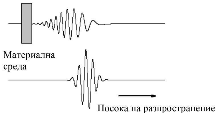
Фиг. 4 Пример за удължен и честотно модулиран импулс след преминаване през материална среда (горе); импулс във вакуум (долу).
