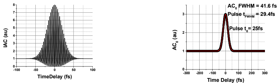
Фиг. 8 Интерферометрична автокорелация от втори порядък IAC (лява графика) и извлечената от нея чрез Фурие-преобразувания интензитетна автокорелация AC_0 (дясна графика).
