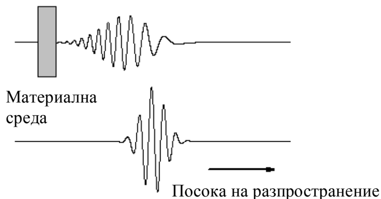
Фиг. 3 Пример за удължен и честотно модулиран импулс след преминаване през материална среда (горе); импулс във вакуум (долу).
